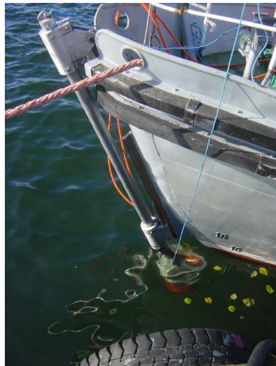
Figure 10 EM 3002 installation examples
